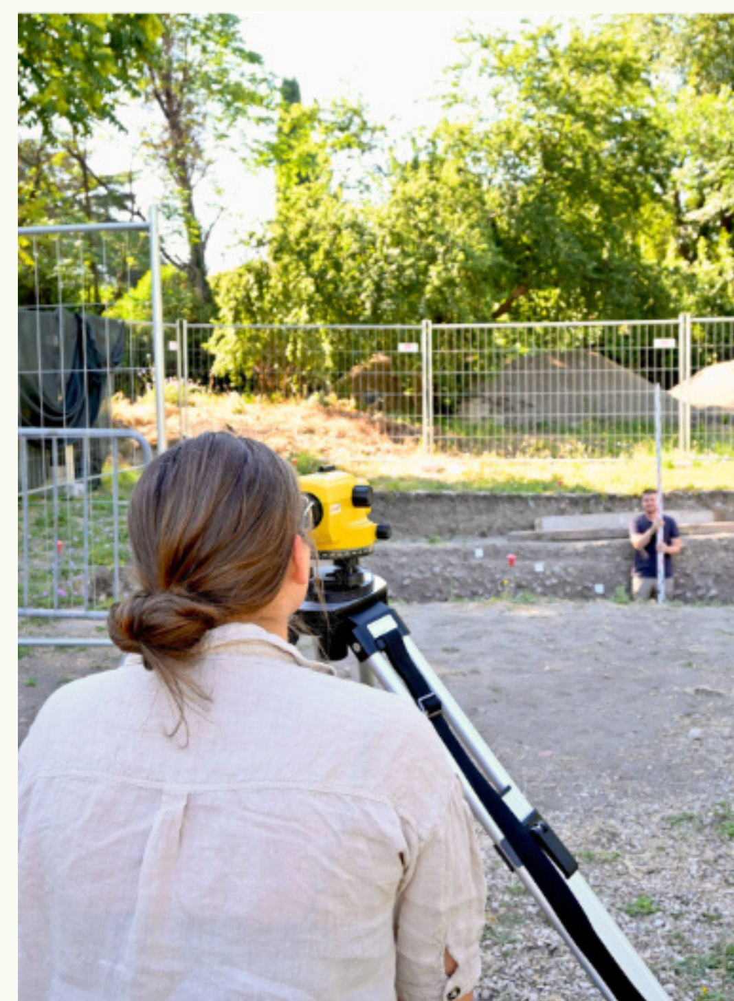
Fig 4: la documentazione manuale dedicata alla quotatura verticale, utilizzando il livello ottico (primo piano) e la stadia (secondo piano).
